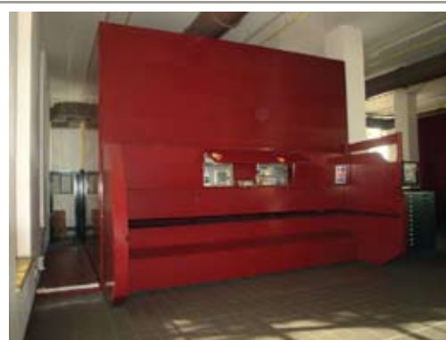
Вертикалі: архіви, організовані по принципу вертикальної каруселі, поверхні які обертаються. Ідеально підходять для утримання та управління документами всіх видів або товарами невеликого об'єму
